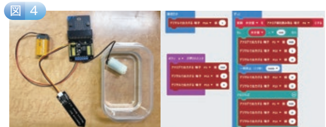
micro:bitを用いた自動かん水装置とプログラム
