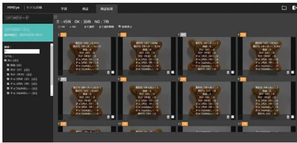
図2 MMEyeによる不良の傾向分析の画面
