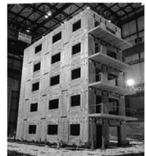
CLTで製作した建築物の振動実験の様子
