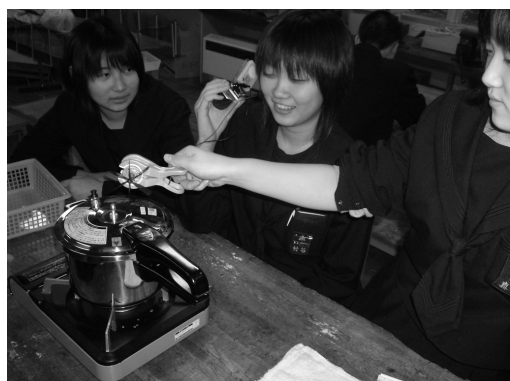
図3 圧力鍋を使った火力発電の実験
