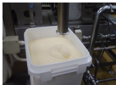
配管の洗浄で、配管から取り出されたマヨネーズ
