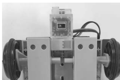
赤外線センサーを床に向けように取りつける
