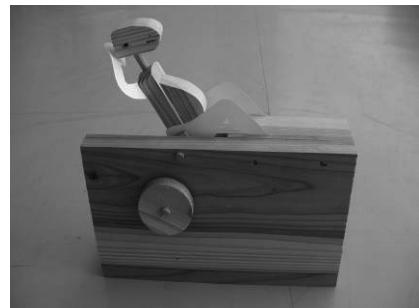
生徒作品では2種類の機構の活用が見られた。上の作品はカム機構を使って1回転で2回の遙動運動を作っている。下の作品は遙動スライダクランク機構を使い1回転で1回の遙動運動を作っている。どちらも機構をうまく活用して課題解決につながっている。
