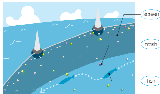
▲ 垂れ下がったスクリーンは網ではないため、生物はからまることなく海流とともに下に流れていくしくみになっています。
